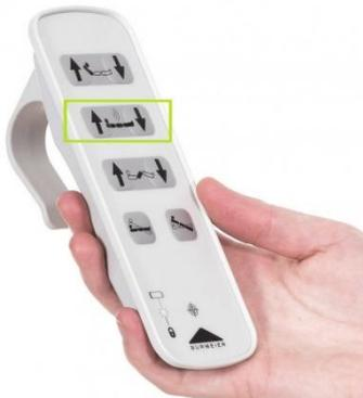
**2. Schritt:** Halten Sie den Handschalter nahe zur Rückenlehne des Bettes und drücken Sie die beiden Tasten für die Höhenverstellung gleichzeitig für mindestens 5 Sekunden.
