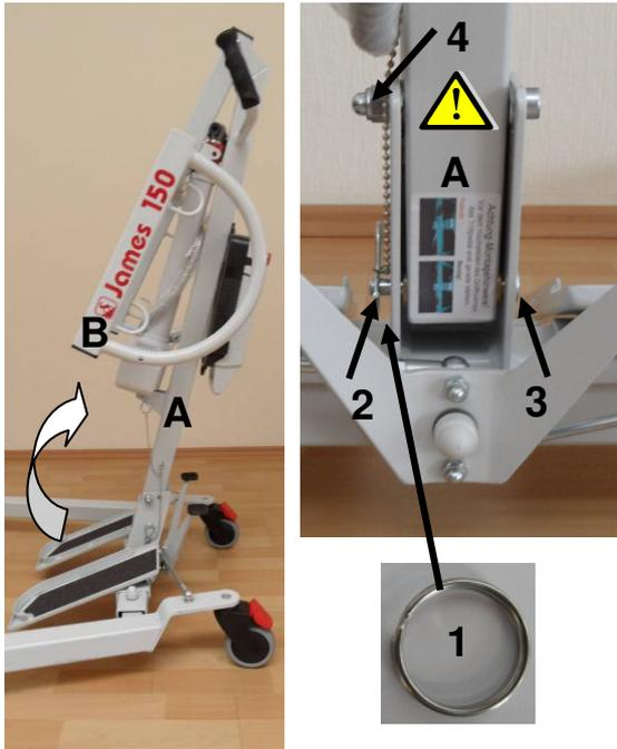
Durch das Einstecken des Bolzens (3) in die Bohrung wird der Griffholm (A) arretiert. Anschließend sichern Sie den Bolzen gegen Herausrutschen mit dem Federstecker (2) oder Schlüsselring (1) und ziehen die Hutmutter M10 (4) am Griffholm (A) fest an.
