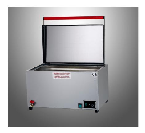
Das HEUSER Wasserbad WB4-30/4 eignet sich zur Erwärmung von 5 Wärmeträgern (Größe 1). Die Temperatureinstellung erfolgt mittels Thermostatrad im Bereich von 30 – 85 °C. Durch die großflächige Silikonheizmatte erfolgt die Erhitzung gleichmäßig und schnell. Die energiesparende Isolierung des Gehäuses hilft gegen Wärmeverluste. Durch den Einsatz eines Wasserbads erhitzen Sie Ihre Wärmeträger schonend und haben diese immer mit der eingestellten, gewünschten Temperatur griffbereit.
