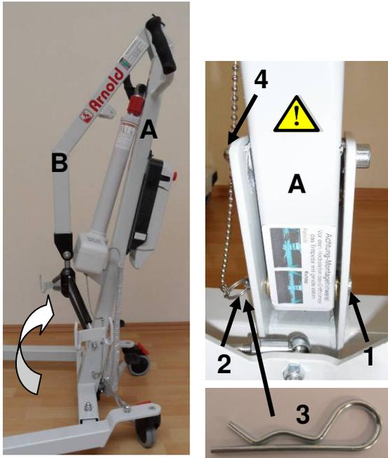
Durch das Einstecken des Bolzens (1) in die Bohrung wird der Griffholm (A) arretiert. Anschließend sichern Sie den Bolzen gegen Herausrutschen mit dem Schlüsselring (2) „oder Federstecker (3)“ und ziehen die Muttermutter M10 (4) am Griffholm (A) fest an.
